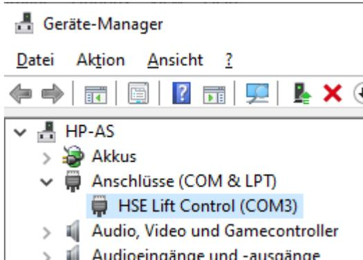
Die Treiberinstallation ist erfolgreich, wenn die Hauptsteuerung "HSE" hier aufzufinden ist. Der angezeigte COM-Port kann variieren.
